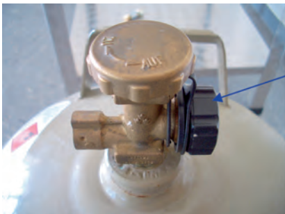
Abb. 28: Flaschen-Absperrventil mit aufgeschraubter Ventilverschlussmutter
