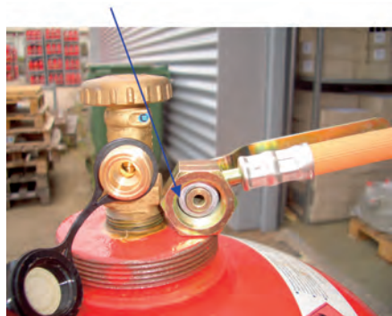
Abb. 15: Absperrventil 33-kg-Flasche und Hochdruckschlauch mit Dichtring aus Aluminium
