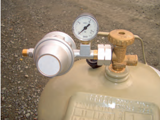
Abb. 24: Beispielhaftes Druckregelgerät mit integrierter Überdrucksicherheits- einrichtung und Manometer
