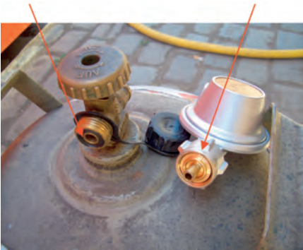
Abb. 14: Absperrventil 11-kg-Flasche mit Gummidichtring im Entnahmestutzen und Druckregelgerät
