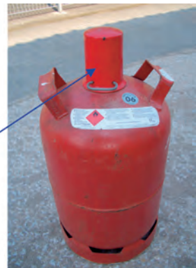
Abb. 29: Flüssiggasflasche mit Ventilschutzkappe
