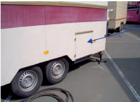
Abb. 30: Von außen zugänglicher Kasten (Schrank) für Flüssiggasflaschen
