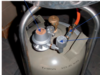
Abb. 27: Erforderliche Sicherheitseinrichtungen (Druckregelgerät mit integrierter Überdrucksicherheitsvorrichtung, Gas-Kippschutzventil, Schlauchbruchsicherung) an Terrassenheizstrahlern
