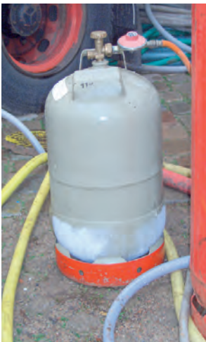
Abb. 3: Flüssiggasflasche mit Reifansatz; Flasche mit nicht geeignetem Druckregelgerät und unzureichende Aufstellung (fehlende Sicherung gegen Umfallen der Flasche, Stolperstellen durch Schlauchleitungen)
