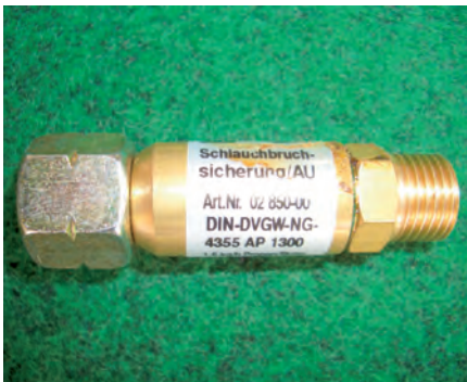
Abb. 20: Beispielhafte Schlauchbruchsicherung (50 mbar, 1,5 kg/h)
