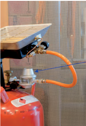
Druckregelgerät mit integrierter Überdrucksicherheitseinrichtung
